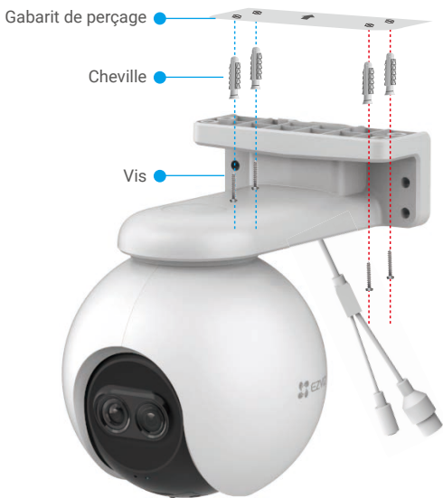
Fig. 1 Montage au plafond
